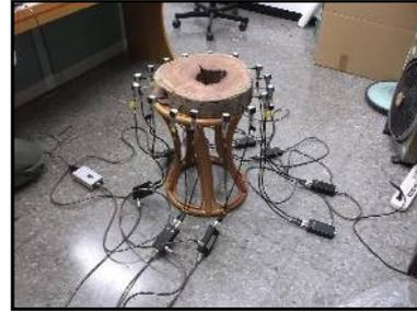
16センサーを設置した計測の光景
